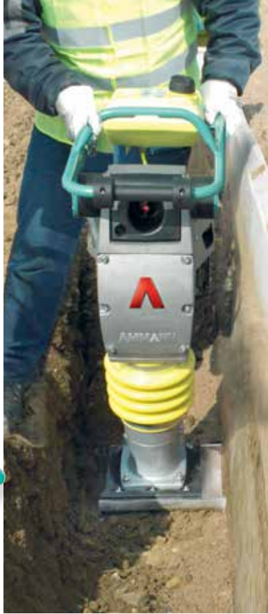
340 mm asimmetrica: lavoro di compattazione in trincee protette da sistemi di armatura senza inclinare il costipatore durante il funzionamento
