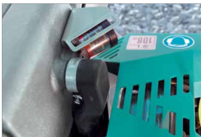
Filtro dell'aria voluminoso ma fitto con funzione autopulente, dotato a scelta di un dispositivo di prepulizia a ciclone e una spia per l'assistenza (consente di allungare gli intervalli di assistenza di cinque volte)
